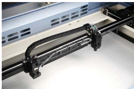
Imagen 8: grabadora equipada con doble cabezal.
