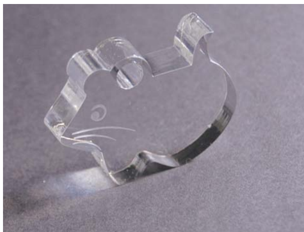
Imagen 2: acrílico de 30 mm. cortado con láser.
